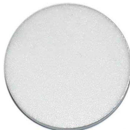
Presstablette, hergestellt durch freies Verpressen
