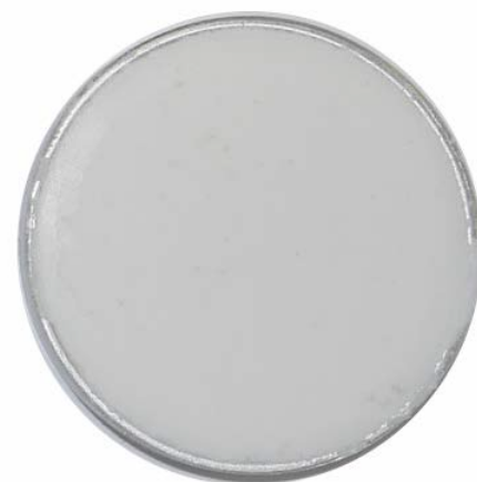
Presstablette, hergestellt durch Verpressen in Aluminiumschale
