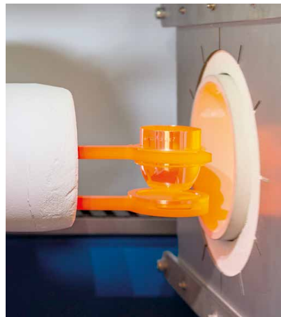
Rotglühender Tiegel und Ausgießschale aus Platin/Gold nach Aufschluss
