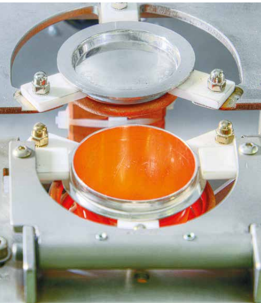
Aufschluss durch Induktion mit Hochfrequenz
