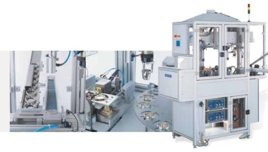
Die HA-HF16 ist ein kompaktes Modell innerhalb unserer Aufschluss-Systeme und besonders geeignet für die Zementindustrie. Der vollautomatische Ablauf des Schmelz- und Abkühlvorganges gewährleistet optimale Ergebnisse.
