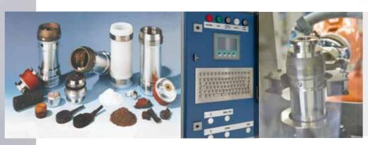
Unser Airtube-System gestattet den zuverlässigen und raschen Probentransport ins Labor. Unsere jahrzehntelange Erfahrung auf diesem Gebiet ermöglicht die Installation auch unter schwierigen räumlichen Bedingungen oder über größere Distanzen. Durch unsere Sende- und Empfangsstationen erfolgt die automatische Integration der Probeninformationen in das LIMS bzw. unsere Steuerungssoftware PrepMaster.
